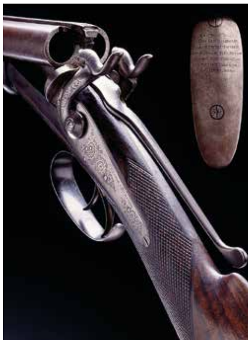
Pierwsza strzelba odtłocowa sprzedana przez firmę Westley Richards z charakterystyczną długą dźwignią klucza i typowym dla firmy zamknięciem „doll's head”. Na metalowej stopce wygrawerowane dane właściciela, cena i rok produkcji
