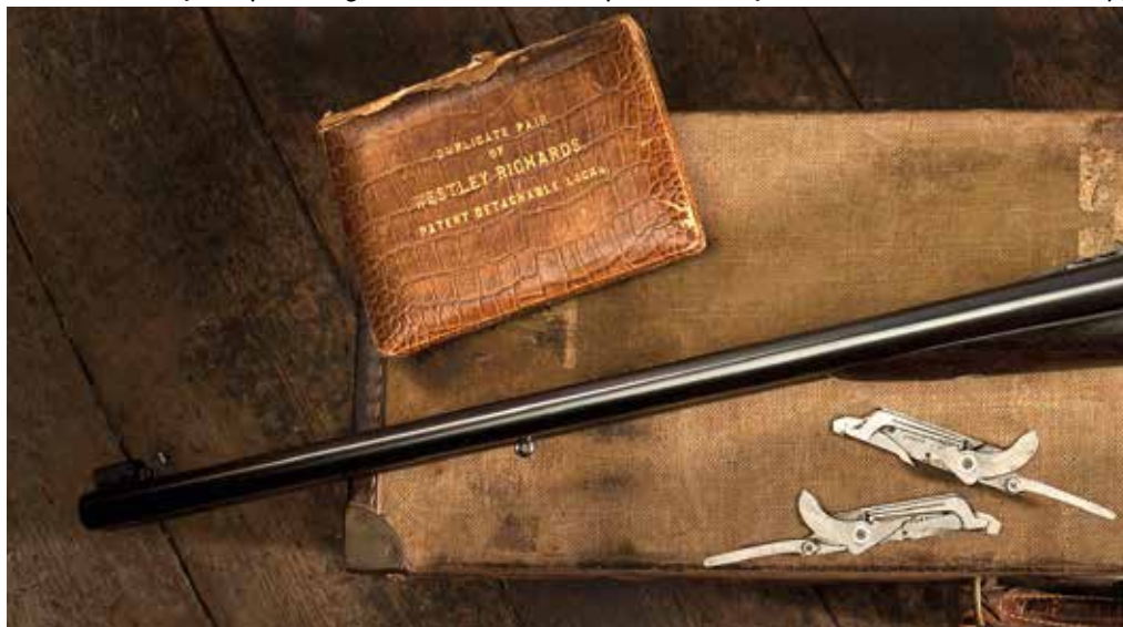
Jednospustowy ekspres Jamesa Sutherlanda w kalibrze .577, wykonany w 1906 roku. Na zdjęciu widoczne zamki wymienne broni
