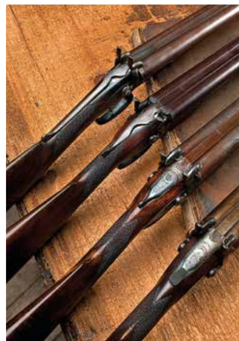
Cztery strzelby pokazujące ewolucję stosowanych przez firmę dźwigni kluczy zamykających broń, wykonane w latach 1862–1865
